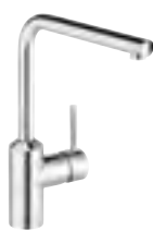
428170577 egykaros, bajonettzáras mosogatócsap NA 10 ablak alá szerelhető, kiemelhető kivitel elfordítható kifolyó (360°) H1 305, H2 280, A 210, Ø1 35, Ø2 48
